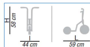
**Caractéristiques** : revêtement antirouille et résistant aux chocs, plateforme antidérapante et deux roues arrière pour une meilleure stabilité, roues pleines anti-coincement en caoutchouc, poignées antidérapantes, conçu pour un usage intensif en collectivité tout en assurant un maximum de sécurité, sans phtalates, sans PVC, facile à monter.
