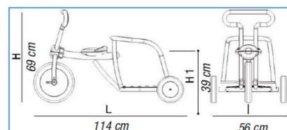
**Caractéristiques :** Cadre en acier d'une grande robustesse, peinture époxy antichocs, poignées ergonomiques et antidérapantes, roues pleines d'une grande résistance à l'usure, système anti-coincement des doigts au niveau de la fourche, pédales conçues pour un usage intensif, plateforme arrière protégée par un tube tournant et son revêtement antidérapant peut accueillir un enfant assis ou debout en toute sécurité.
