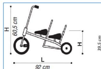
**Caractéristiques : En acier peint, roues modelées par injection, pneus pleins, selles ergonomiques et confortables, pédales antidérapantes.**
